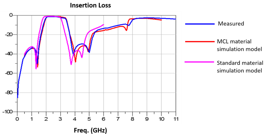
図3: 標準シミュレーションおよびMCLの材料構造を加味したシミュレーションによるLTCCバンドパスフィルタのS21と初号機の実測値
