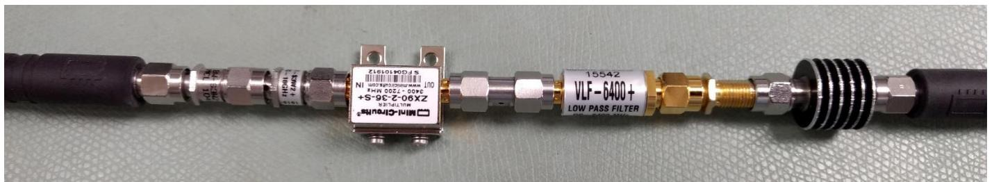
図 15: (上) 無反射フィルタと 2 過倍器の組合せ (下) 反射フィルタと 2 過倍器の組合せ。
