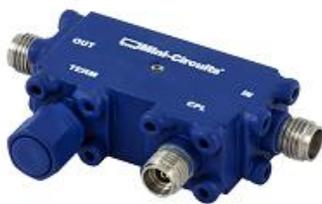
Mini-Circuits ZCDC20-E18653+ は 18~65GHz の周波数範囲において公称 20dB の結合度を備えた同軸タイプの方向性結合器です。このモデルは最大 12W の RF 電力、最大 0.48A の DC 電流を入力できます。
